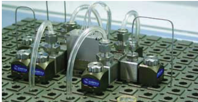
Bild 2. Ehrfeld Microtechnik har ett system där reaktorer, pumpar och värmeväxlare är utformade som moduler vilka kan arrangeras efter önskad utformning på en basplatta som visas på bilden intill. En enklare, fungerande uppställning som det på bilden intill kostar uppskattningsvis 0,5-1 miljon kronor.
