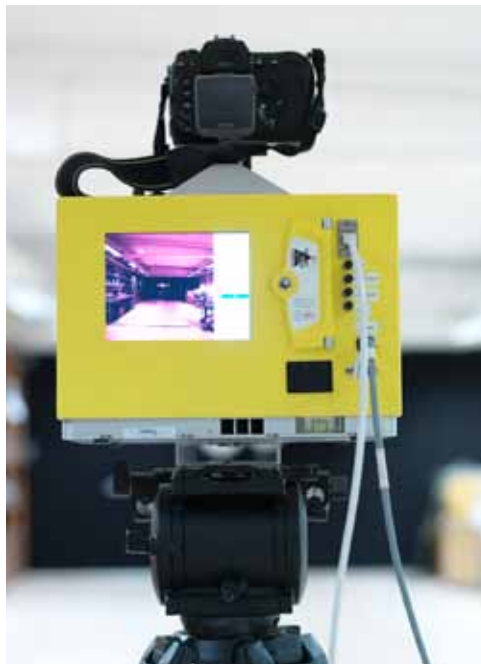
Skannande 3D LADAR (Laser Detection and Ranging) med hög positionsnoggrannhet.
