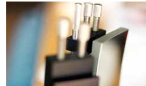
Detaljbild från en integrerande sfär som kan användas för att mäta diffus reflektans.
