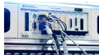
Multikanalsystem för insamling och analys av akustiska signaler.
