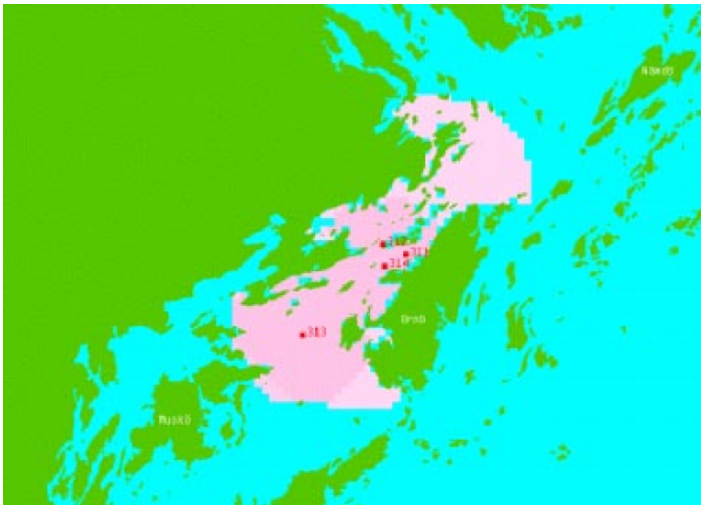
Bild 1 ( Dezzy ): Evidenskarta. Olika färgnyanser anger olika trolighetsgrad för att en misstänkt ubåt vid en viss tidpunkt uppehåller sig inom området ifråga. Röda prickar anger observationer, gula linjer utmärker sensorer (både observationer och sensorer är här fiktiva).
