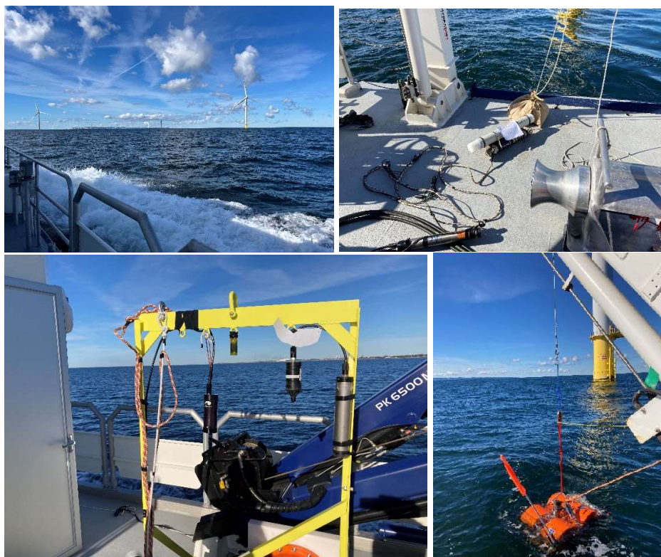
Figur 2. Bilder från mätningar vid Kriegers Flak. Uppe till vänster: Fartyget Ocean Nomad ankommer vindkraftsparken. Uppe till höger, ett av hydrofonsystemen redo för sjösättning. Nere till vänster: Partikelrörelsesensor (svart cylinder till vänster) och en hydrofon (svart spetsig cylinder till höger) fästa på sin ställning (gul). Nere till höger: en OBSer sjösätts nära ett vindkraftverk och dess fundament.
