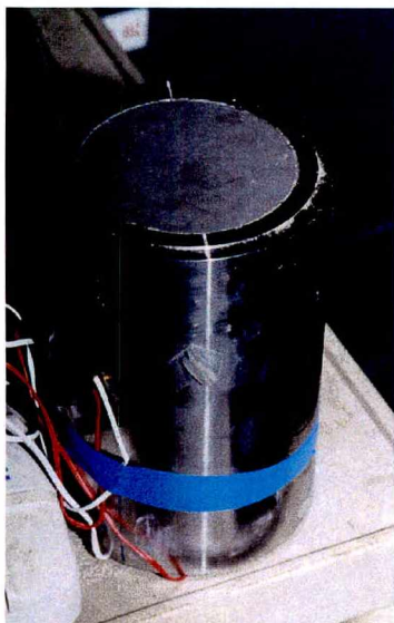
Figur 9.1. Den ingjutna betongcylindern Figur 9.2. Cellen med ingjuten provkropp i i stålroret (GREAK-cellen) med provningsmaskinen. Lastkapacitet 3MN. töjningsgivare limmade på mantelytan.
