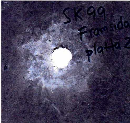
Figur 6.19. Skott # 99, detalj av ingångshål i bakre plattan. Platta #1.
