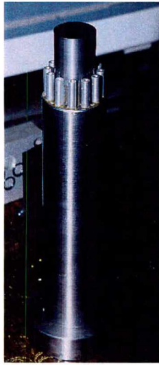
Figur 9.9. Tryckstav för axiell belastning av provkroppen med 12 genomföringar av elektriska signaler. Figur 9.10. Stålbehållare med rosettprovkroppen med 12 genomföringar av elektriska signaler för mätning av yttre töjningar.
