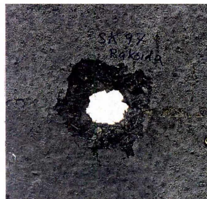
Figur 6.12. Skott #97, detalj av utgångshål i platta #3.
