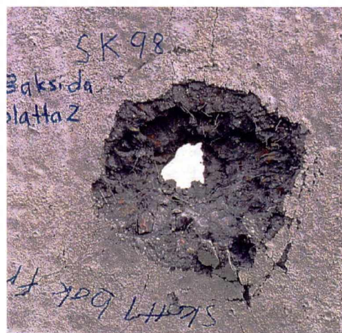
Figur 6.16. Skott # 98, detalj av utgångshål i bakre plattan. Platta # 2.
