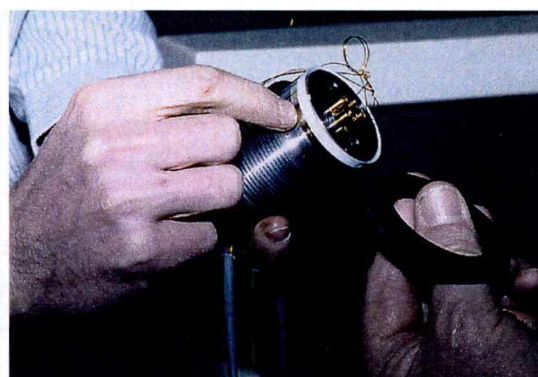
Figur 9.8. Tätning av förslutningen med gummi packning med speciellt anpassad profil och säten för att klara höga tryck.
