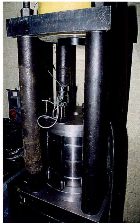
Figur 9.11. Hydraulisk cylinder inbyggd i en tryckförstärkare. Figur 9.12. Cellen för hydrostatiskt tryck rigg för axiell belastning av provkroppen matas med oljetryck underifrån ovanifrån.
