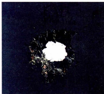
Figur 6.11. Skott #97, detalj av ingångshål i platta #3.
