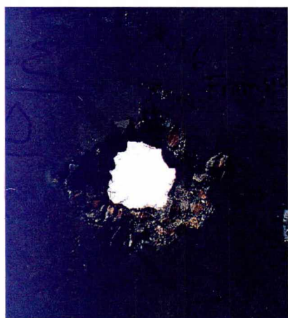
Figur 6.9. Skott #96, detalj av ingångshål i platta #3.
