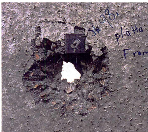
Figur 6.13. Skott # 98, ingångshål främre plattan. Platta #1.
