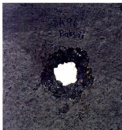
Figur 6.10. Skott #96, detalj av utgångshål i platta #3.
