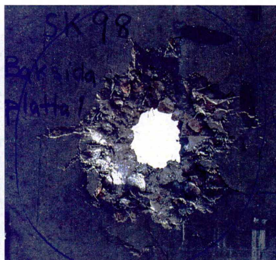
Figur 6.14. Skott # 98, utgångshål främre plattan. Platta #1.
