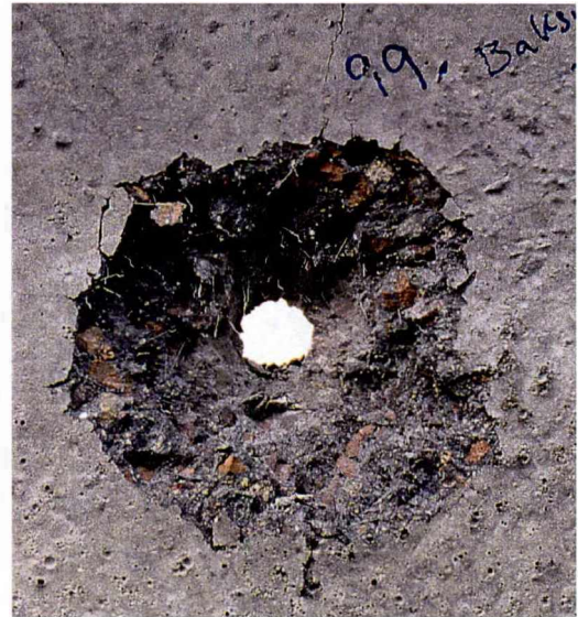
Figur 6.19. Skott # 99, detalj av ingångshål i bakre plattan. Platta #1.
