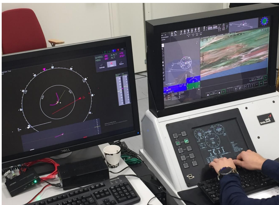
Figur 1 Skeldar GCS (t.h.) med DAA-display (t.v.) under pågående undanmanöver.
