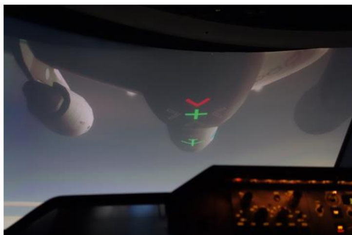
Till vänster en övervakningsdisplay av de olika faserna av lufttankningen med en vy uppfifrån, från sidan och aktuell fas i grönt i kolumnen till höger. Bilden till höger är ett fotografi inifrån simulatören under flygproven av systemet.
