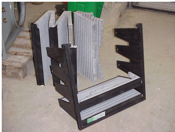
Figur 58. Bild av skador på hölje efter skott 19. Figur 59. Bild av skador på filter efter skott 19.
