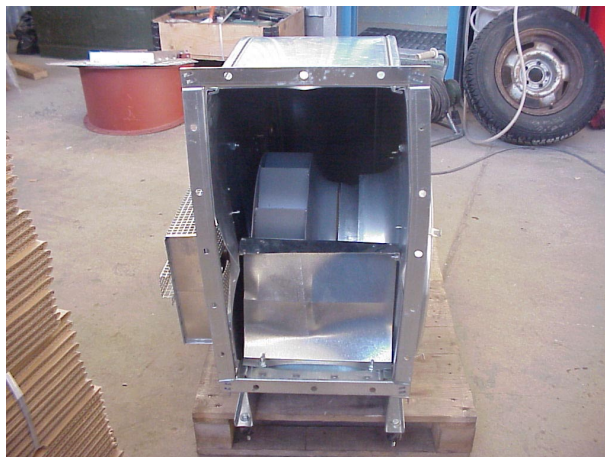
Figur 50. Bild av skadat hölje efter skott 13.
