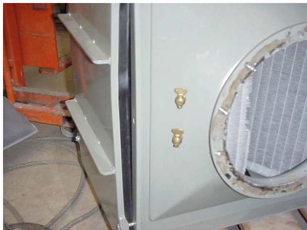
Figur 58. Bild av skador på hölje efter skott 19. Figur 59. Bild av skador på filter efter skott 19.
