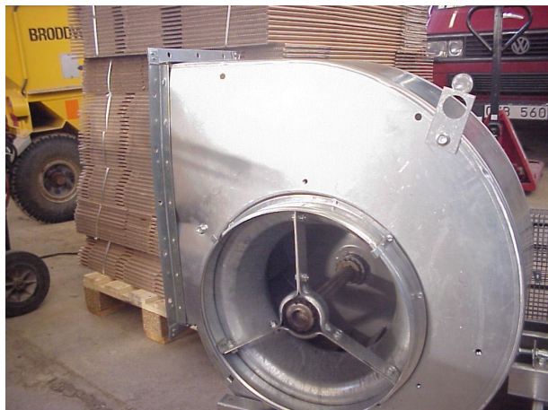
Figur 49. Bild av skadat hölje efter skott 13.
