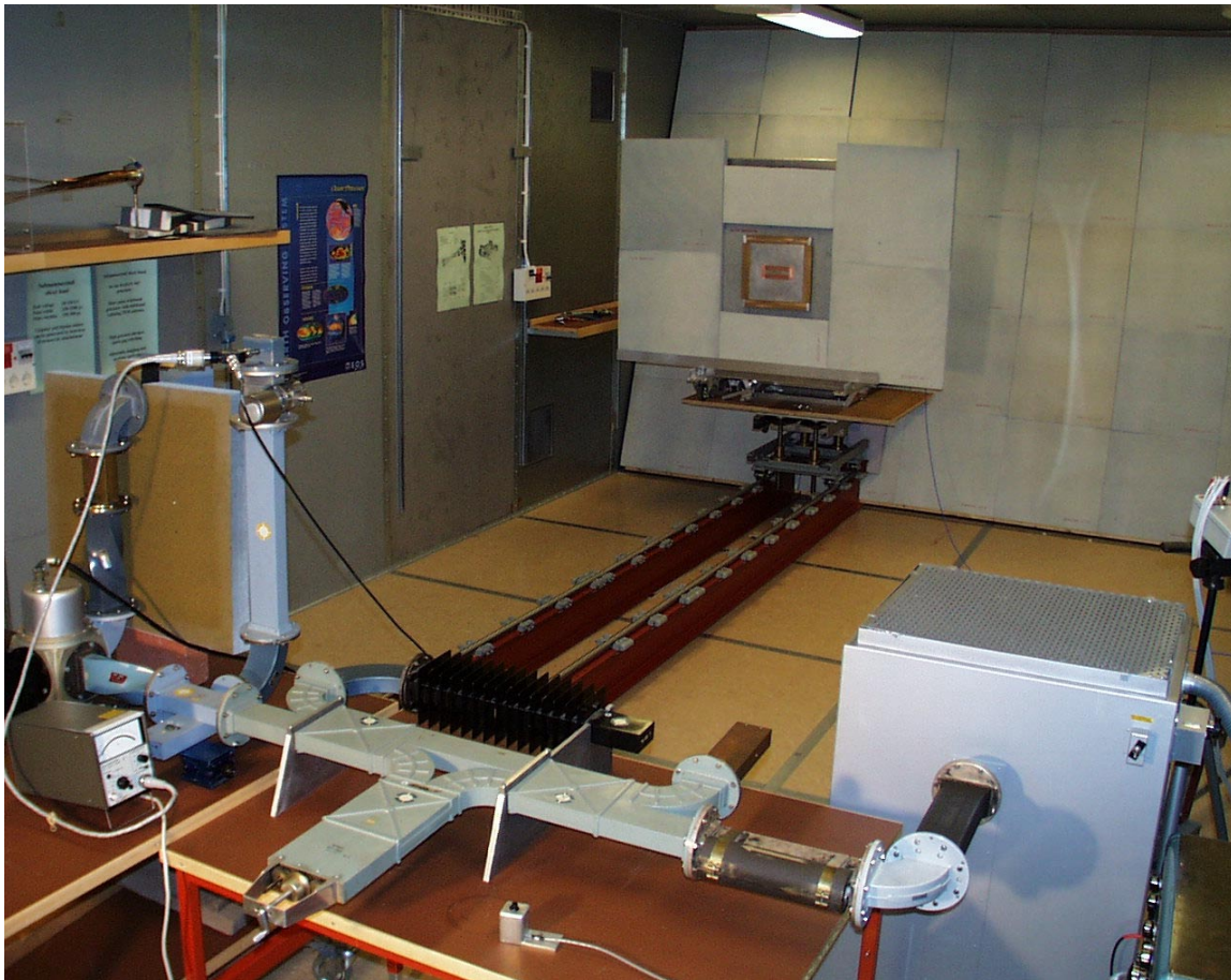
Figur 1. Mätuppställning med 700 kW magnetron till höger, sändarantenn till vänster och kiosken försedd med slitslucka på rälsen i 4284 mm läget.
