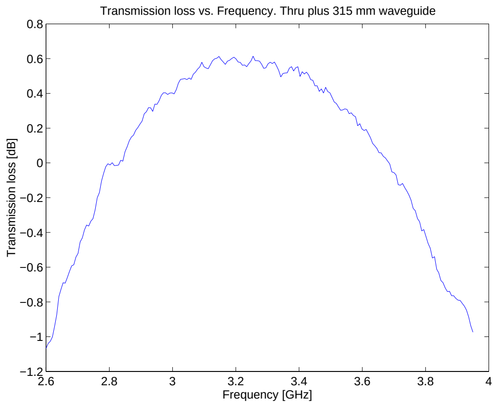
Figur 12. Transmissionsförluster i systemet ( korskopplarens avvikelse från 30 dB)
