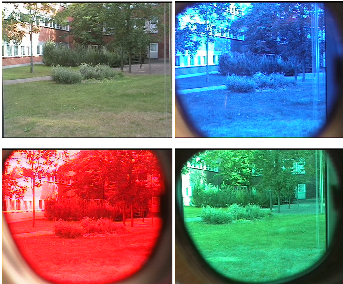
Figur 27 Färgbalansen försämras av spektrala filter.
