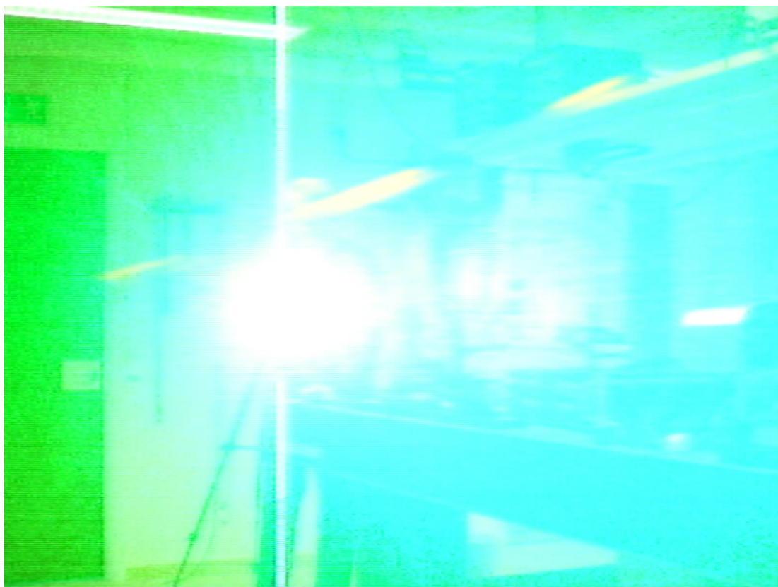
Figur 11 Bild från videokamera bländad av en 1 mW dubblad Nd:YAG laser.
