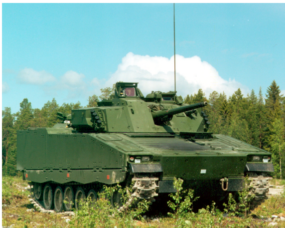
Figur 14 Stridsfordon 90 är försett med en Nd:YAG avståndsmätarlaser. Foto: Hägglunds Vehicle
