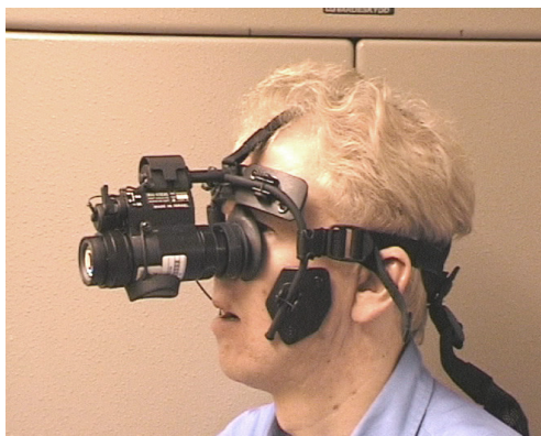
Figur 28 Indirekt seende. Med "Night Vision Goggles" skyddas ögonen från skada.
