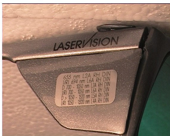
Figur 25 Exempel på märkning av skyddsglasögon. Dessa har god dämpning i området 700-1500 nm.
