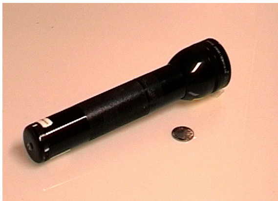
Figur 18 Handhållen laserficklampa som ger 1 W kontinuerlig effekt vid 850 nm.
