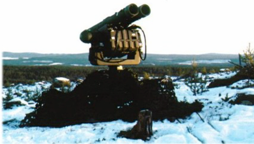
Figur 15 I robot 90-systemet styrs roboten av en laserledstråle, diodlaser, nära IR. Photo: Lv 7, Boden
