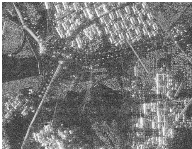
Figur 7.1: SAR-bild producerad med CARABAS-systemet. Ett utsnitt över stadsdelarna Ryd och Valla i Linköping.
