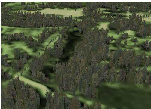
Figur 12: Markmodell med vegetation. Alla trädparametrar är framtagna ur laserradardata. Högra bilden visar ca 35 000 enskilda träd.
