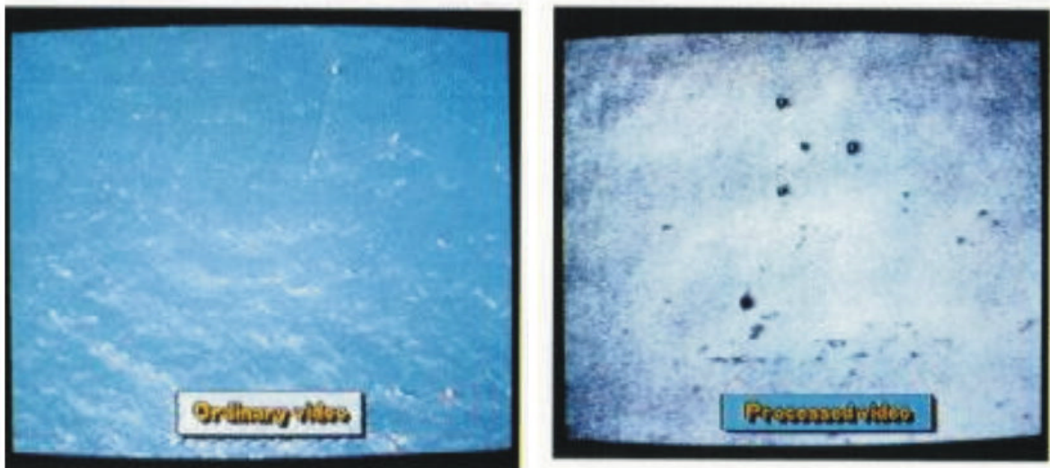
Figur 32. Detektion av minor eller minlika objekt i strandzon med passiv multispektral teknik, bild DSTO.
