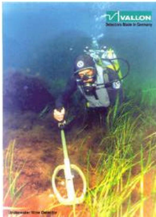
Figur 12. I figuren visas en minsökarutrustning av modell MW1630B som har detektionsdjup på 2 m i normalbotten.
