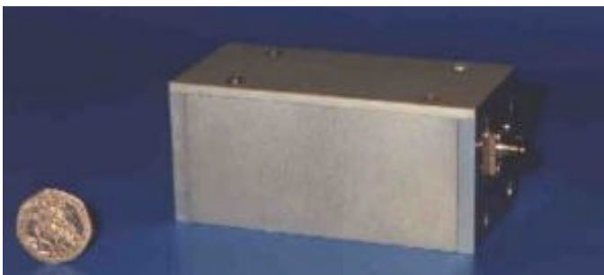
Figur 18. Överst visas en ROV för minklassificering utvecklat av Marconi i England. Nederst visas en Q-switchad s.k. mikrochiplaser som genererar 1 ns långa pulser vid ca 20 kHz prf för full 3D-avbildning. Laserns toppeffekt i grönt är ca 4 kW.
