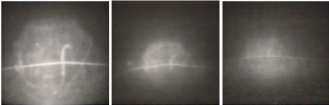
Figur 20. Bilder från tester med Sea Ray för att upptäcka mantaminor på avstånd 0,4 m, 3 och 5 m från lasern. Mätningarna är gjorda i Brest, Frankrike. Vattenkvaliteten är av hamnkvalitet med <1 m dämpningslängd.
