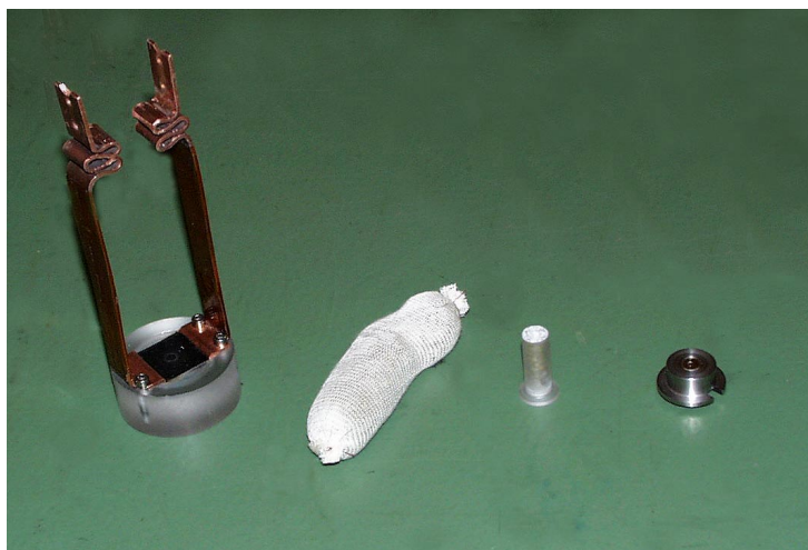
Figur 6. Från vänster: hållare med limmad testladdning (svart) inklämd mellan elektroderna samt tilledere, tygpåse med boosterkrut, tändladdning och tändhatt i hållare.
