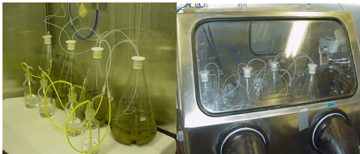
Figur 1. Försökupställning, bilden till vänster visar en aerob upställning med KOH-fällor, (Stora Pölsan A-D). Till höger ses kolvar placerade i anaerobbox (Fårö A-D).
