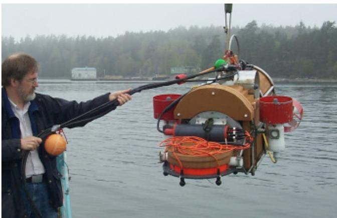
*Figur 1. PLUMS (Plattform för Undervattens MätSystem) som användes vid försöken med detektering av begravda objekt. Den penetrerande sonaren sitter monterad i fronten och är här vinklad nedåt.*
