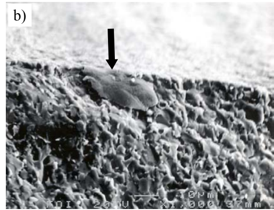
Figur 17: (\text{TiB}_2)_{0,95}(\text{Ti})_{0,05} , 1911c. Två närliggande anvisningar i ytan med mindre brottspegelar. Ett större flakformat korn i den högra anvisningen (figur 17b).
