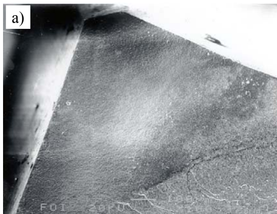
Figur 11: \text{Al}_2\text{O}_3 , 1712c. Stor brottspegel i anslutning till hörn. Ojämn yta nära brottinitieringen.
