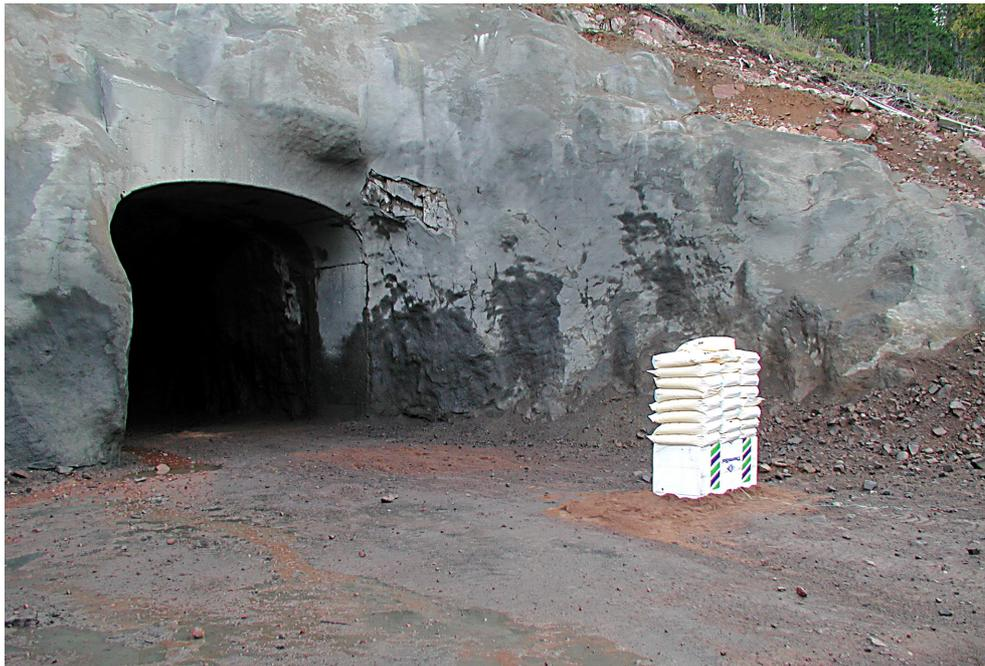
Bild 3. En 625 kg laddning på 10 meters avstånd från tunnelmynningen.
