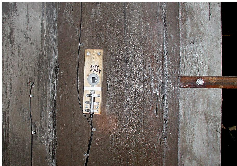
Bild 2. Montering av givare P24 på baksidan av barriären.
