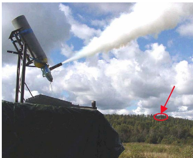
Figur 8. Utsläpp av ammoniak. Instrumentens placering är markerade med rött (A).
