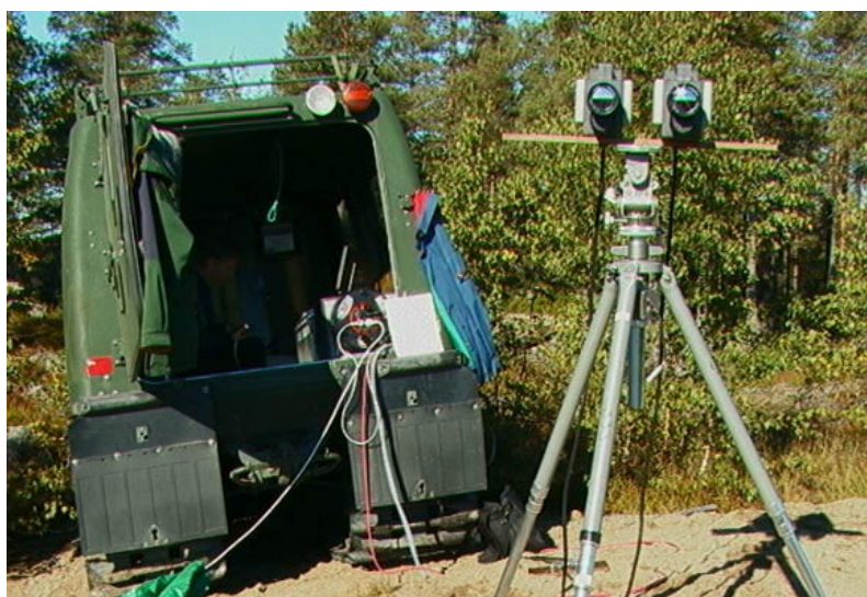
Figur 5. Till vänster: Thermovision 900 med de två IR-kamerorna på stativ och systemenhet med operatör i bandvagnen. Till höger: Spektral känslighet för LWIR-kameran (LPL-filter).
