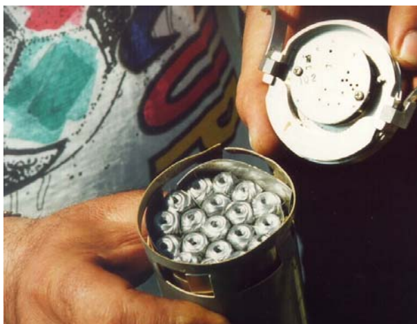
Bild 3.2 Grafitbombens substridsdel innehåller 147 nystan med fiber om vardera 150 meter som sprids över elledningar för att kortsluta systemet. Varje bomb innehåller 202 substridsdelar, dvs totalt 4 454 km strömledande "tråd" som är 6-7 mikrometer i diameter. Källor: Bilden är från CD:n Reconstruction of Electric Power System of Serbia After NATO Air Strikes och uppgifterna från CD:n In the Days of Aggression. Båda har producerats av Electric Power Industry of Serbia.
