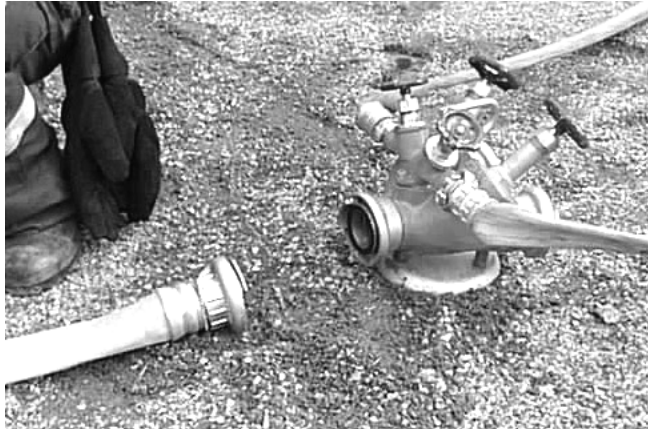
Figur 4. Grov och smalslangarna utlagda som ett "Y" och ihopkopplade med grenrör "kyrka".
