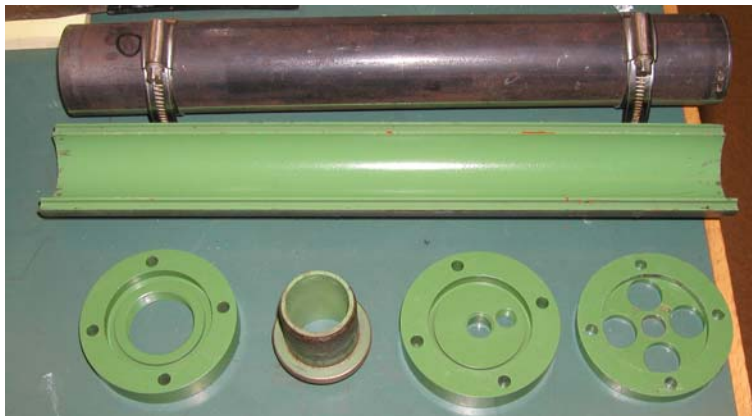
Figur 13. Gjutform med teflonbelagd inneryta, gavlar f r ingjutning respektive utlopp.
