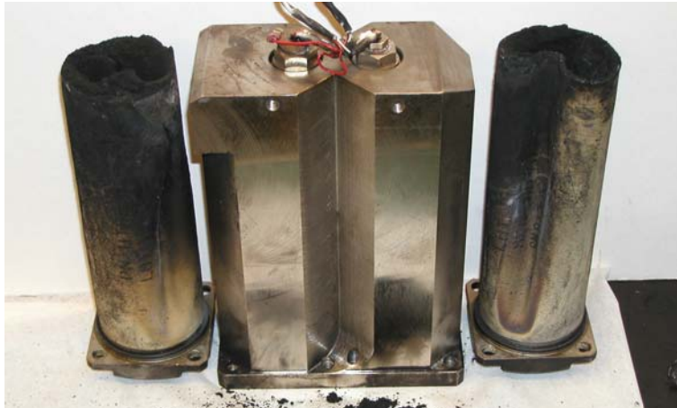
Figur 10. Krutkammare med två utbrända krutladdningar
