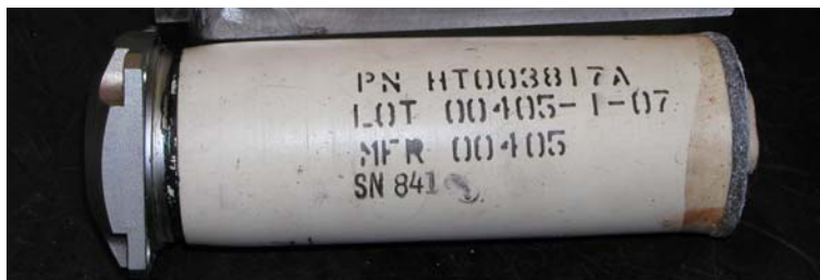
Figur 1. Krutladdning med formförändring efter snabbåldring motsvarade 5 år.
