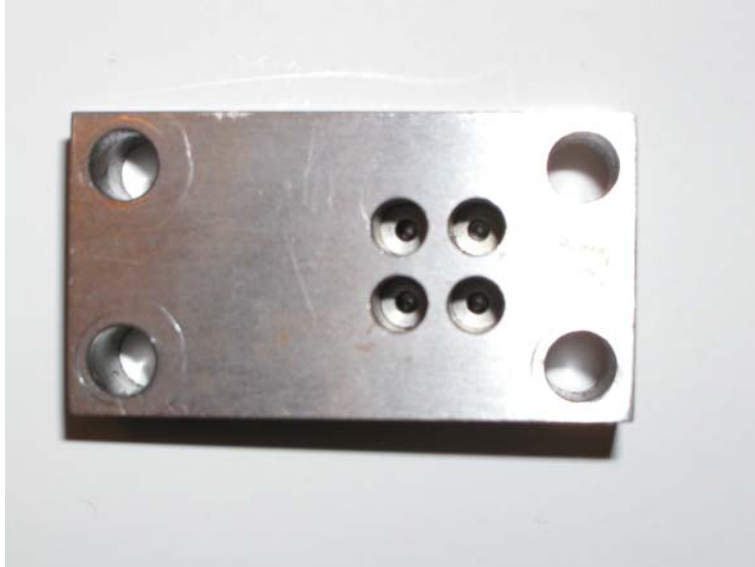
Figur 15. Dysgavel för provbränning
