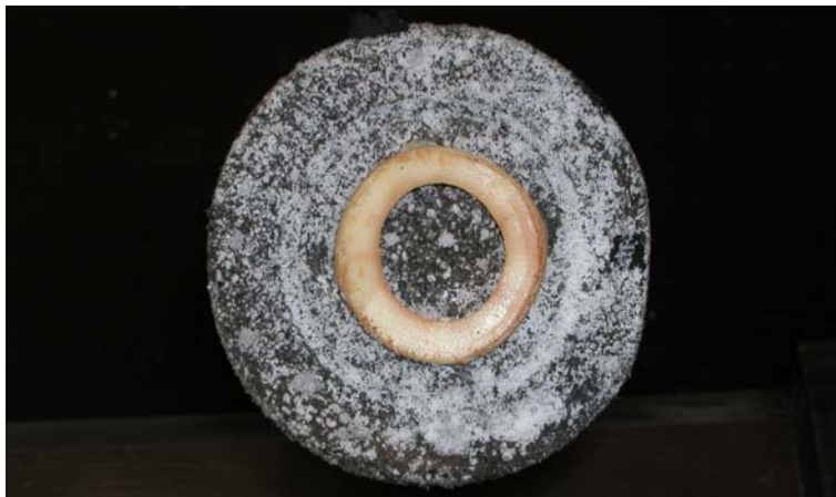
Figur 16. Överförings-/anfyringssats på krutets ändyta.
