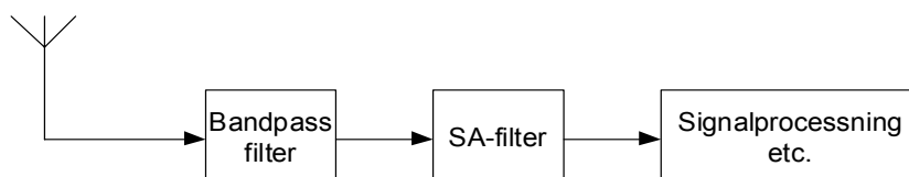
Figur 3.2: Då de utsända radarpulserna har modulationsformen linjär FM uppstår pulskompression i SA-filtret när ekona passerar. För att undvika oönskad interferens används ett bandpassfilter vilket endast släpper igenom frekvenser motsvarande det momentana frekvensbandet. Detta ges av de linjära FM pulsernas frekvenssvep.
