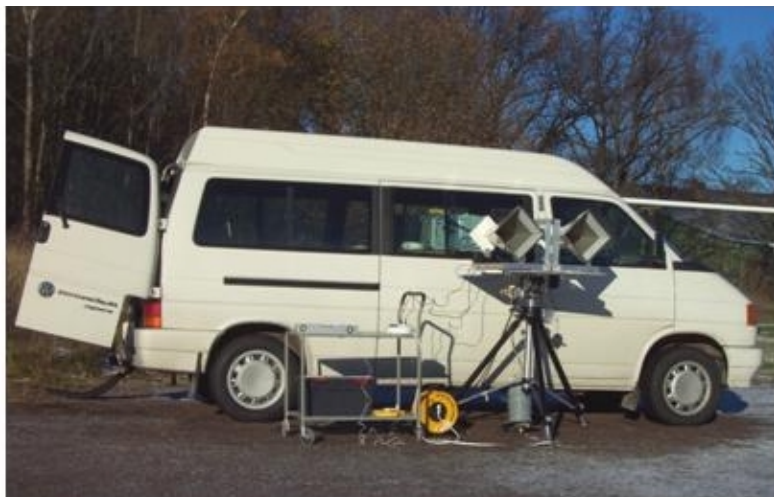
Fig 15 Radarsystem med Gåra-antennerna kopplade till Wiltron 37269 som användes vid RCS-mätningar utomhus under hösten 2001.
