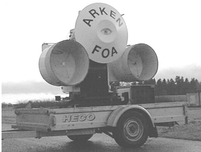
Fig 13 Arkensystemet är ett koherent mobilt radarsystem som arbetar inom 8 -18 GHz.
