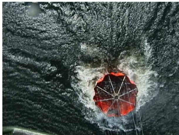
Figur 2.5 Exempel på brandsläckning där en helikopter lyfter ca 2 kubikmeter vatten för att sedan släppa det över branden.
