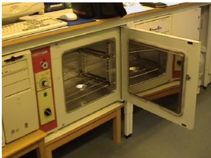
Fig.8. Aluminiumform och värmeskåp som används för torkning av jordprov.
