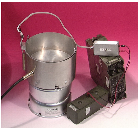
Prototyp n:o 3, 15,6W, med strömbrytare för omkoppling mellan 12 och 24V
