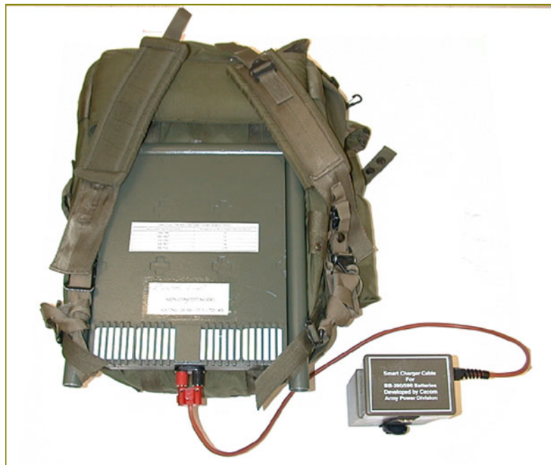
Ryggsäcksanpassat engångsbatteri av zink-luft-typ för laddning av de ordinarie batterierna, eller för direktdrift av strömförbrukare. Bilden från fältproven på Ft Bragg.
