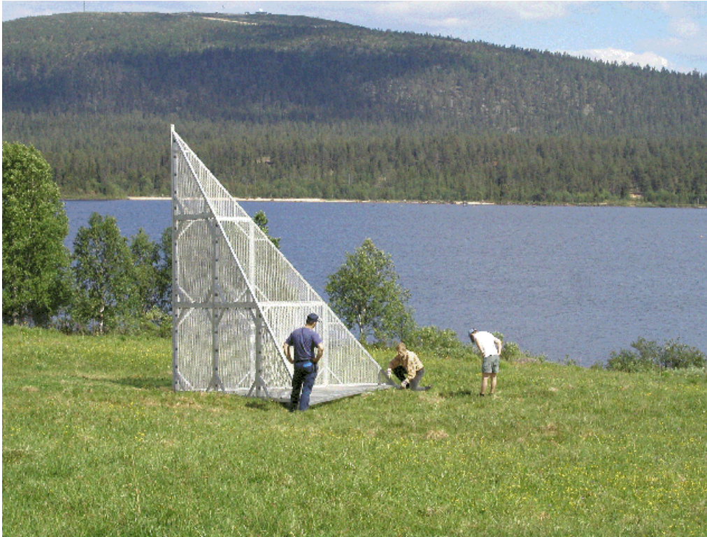
Figur 14. Radarreflektor (tri-hedral) för CARABAS-II placerad nedanför "hotellet" i Nausta by. Genom att lyfta i de två ytterhörnen och vrida kring det inre hörnet kan reflektorn justeras så att den pekar vinkelrätt mot varje flygbana.
