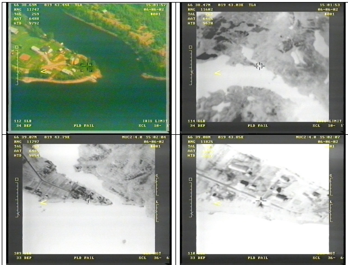
Figur A-4. Zoomkapacitet hos IR-sensorn i 3 steg, jämför tabell 8. Överst till vänster visas en EO-bild av området som referens. I de två övre bilderna indikeras att målföljning pågår då riktkorset kompletterats med en målosäkerhetsindikator i form av en fyrkant.
