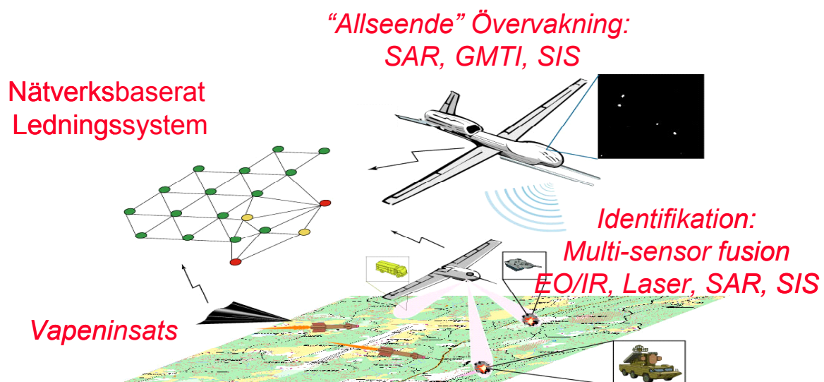
Figur 43. En schematisk skiss över sensorsystem på olika nivåer och med kompletterande delförmågor som samverkar i ett nätverksbaserat försvar för att uppnå ett informationsövertag.
