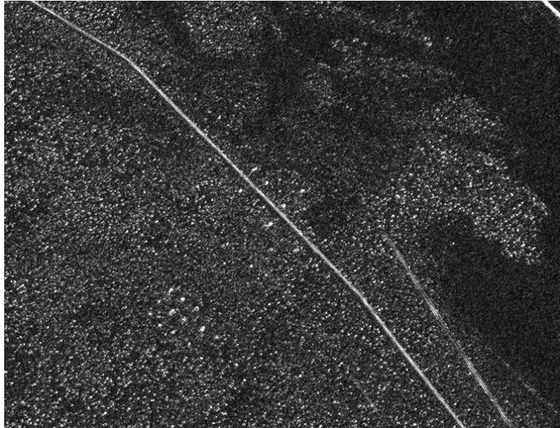
Figur 39. Området kring skog 1 med fordon på plats registrerad torsdagen 7 juni med CARABAS-II VHF-band SAR. Upplösningen är ca 2.5 \times 2.5 \text{ m}^2 . Bilden är kartriktig och radarbelysningen har fallit in mot området i riktning 225^\circ .
