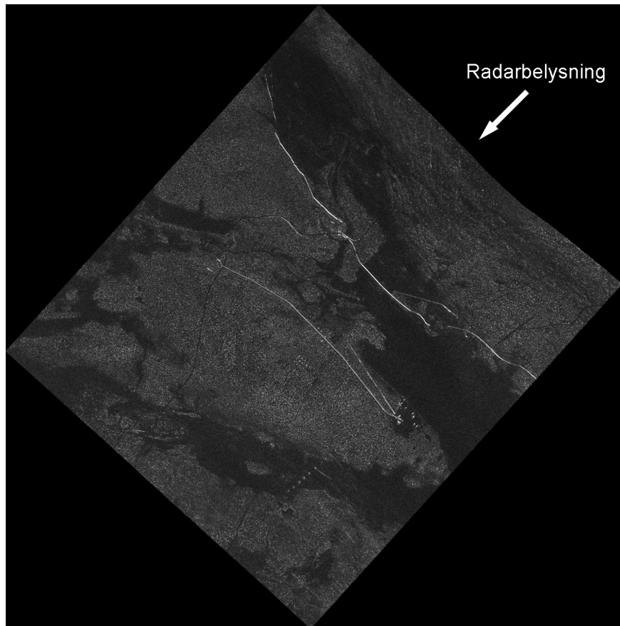
Figur 20. Naustahalvön registrerad fredagen 7 juni av CARABAS-II VHF-band SAR. Under denna dag befann sig samtliga 25 terrängfordon på position inne i skog 1. Radarscenen är kartriktig och finns inskriven inom en kvadratisk yta med storleken 7.7 \times 7.7 \text{ km}^2 .
