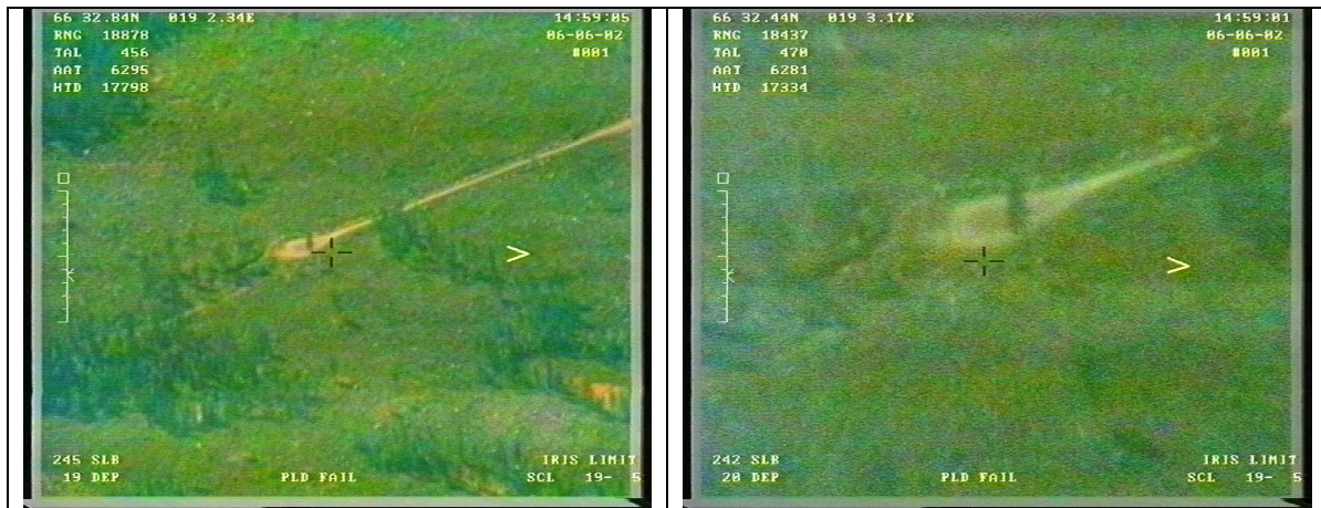
Figur A-3. Bildkvalitet med EO-sensor på drygt 18.5 km avstånd. Maximalt normalzoomläge till vänster och extra telelins till höger.
