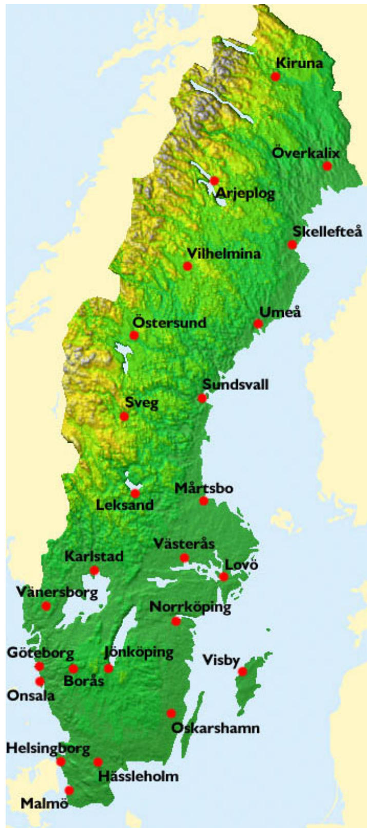
Figur B-1. Platser för de mottagningsstationer i Sverige som ingår (mars 2000) i det nationella SWEPOS-systemet för noggrann positionering baserat på GPS-teknik. (Bild: http://swepos.lmv.lm.se ).
