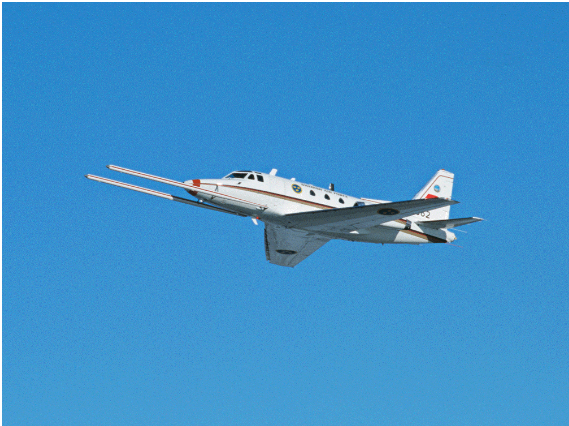
Figur 4. FMV:s provflygplan TP86 Sabreliner med CARABAS-II VHF-band SAR installerad ombord under en flygvapenövning år 2000. (Foto: Försvarets Bildbyrå/Peter Liander).
