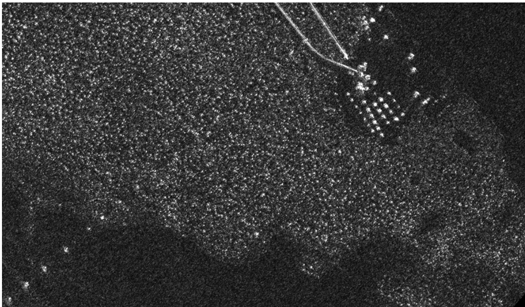
Figur 26. Södra delen av Naustahalvön registrerad måndagen 3 juni med CARABAS-II VHF-band SAR. Upplösningen är ca 2.5 \times 2.5 \text{ m}^2 . Bilden är kartriktig och radarbelysningen har fallit in mot området i riktning 225^\circ .
