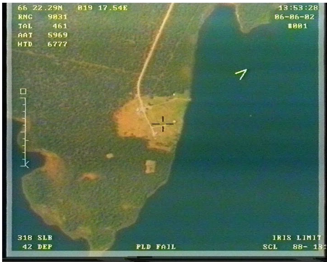
Figur 17. EO-bild över Nausta by. Ur ortofotot i figur 6 framgår att området för skog 1 ligger på ömse sidor av vägen ett stycke bortom den udde som syns i videobildens övre högra hörn. Bland parametrarna som finns överlagrade på bilden återfinns "RNG" som anger att avståndet mellan sensorn och markavsnittet i detta fall är ca 9 km.
