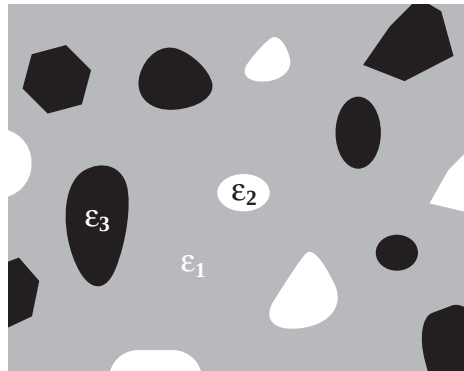
Figur 3: Generiskt inhomogent dielektriskt material. Materialet består av ett matrismaterial med permittivitet \epsilon_1 (grått) med iblandade inhomogeniteter av två materialtyper med permittiviteter \epsilon_2 och \epsilon_3 (vitt respektive svart).
