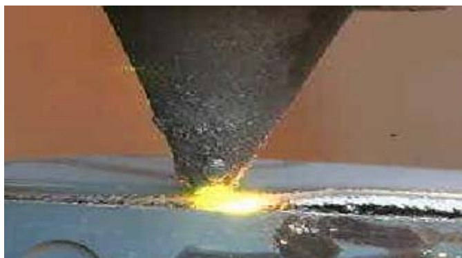
Figur 2, Nd Yag laser skär upp en granat.
