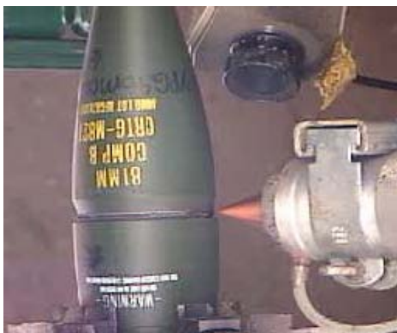
Figur 3, granat skärs upp av rörlig laser.
