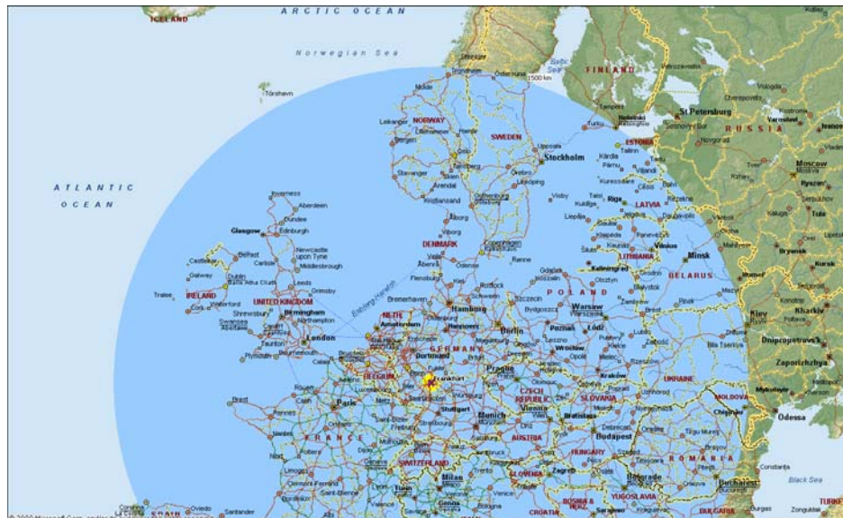
Figur 6: 1500 km radie från Frankfurt (markerat med gult) visar att DCF77 täcker större delen av Centraleuropa.
