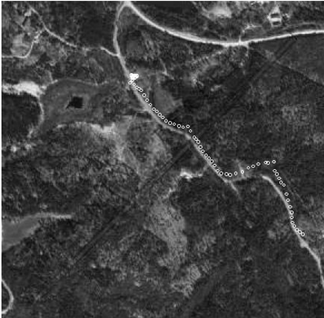
Figur 27. De vita ringarna visar positionen var 5:e sekund som den mättes av GPS-mottagaren. Förflyttningssträckan är en asfalterad körväg på Bogesundslandet, Vaxholm. Flygfoto: Lantmäteriet
