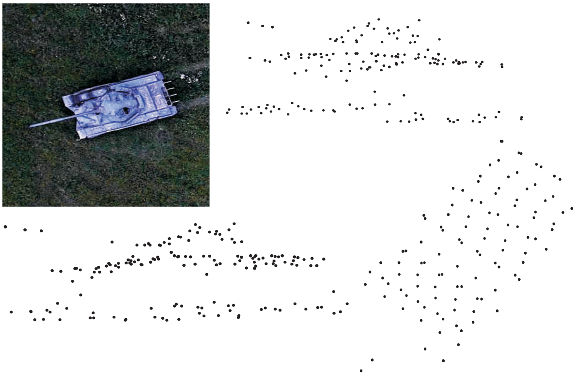
Figur 3. Tre vyer av en stridsvagn; överst till höger: bakifrån; nederst till vänster: sidovy; nederst till höger: toppvy; Överst till vänster: bild från CCD-kameran och övriga från laserradarn.
