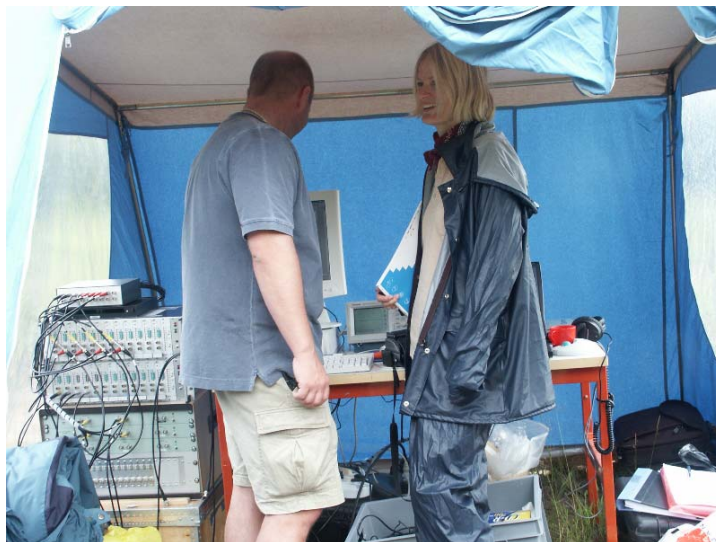
Figur 2. Foto från mättältet. Insamlingsutrustningen står till vänster, seismikutrustningen ovanpå akustikutrustningen.
