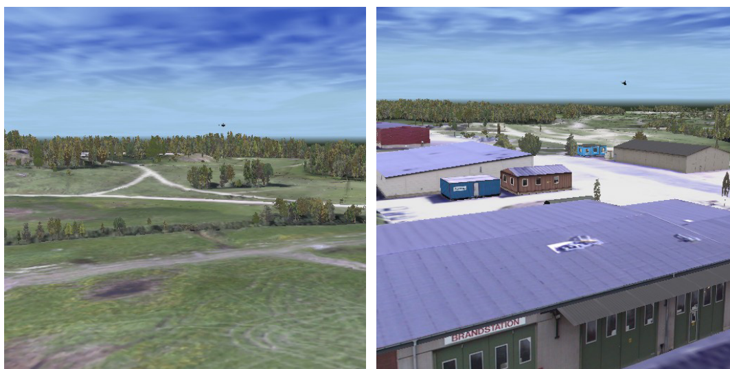
Figur 5.3 Syntetisk vy i 3 D genererad med hjälp av flygburen scannande laserradar (Top Eye) och datafusion med fotografi. Bild – FOI Lasersystem.
