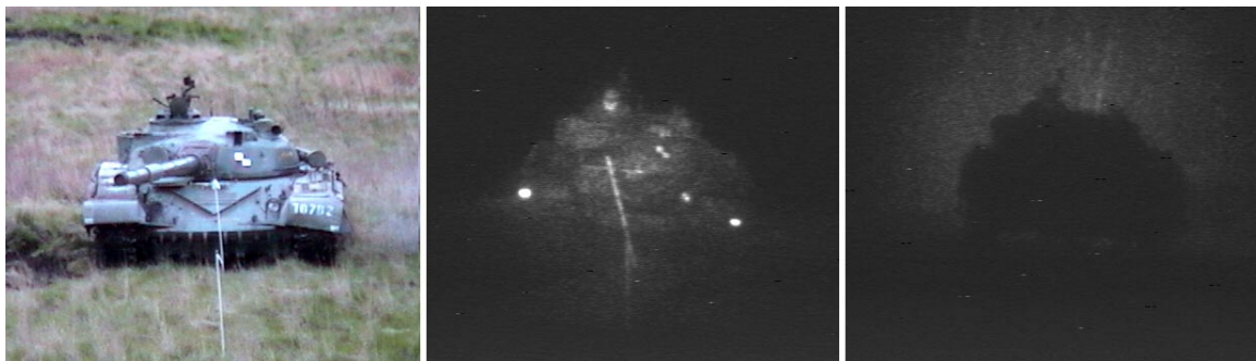
Figur 4.9. En bild av T72an på nära avstånd samt registrering med GV-systemet på avstånd 1905 meter med grindluckan på respektive bakom fordonet.
