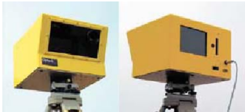
Figur 3.2. Laserskanner Optech ILRIS-3D
