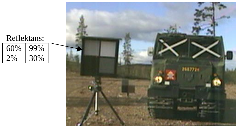
Figur 4.20. Kalibreringstavla med fyra kända reflektanser samt bandvagn som objekt (från Älvdalen-mätningar oktober 2002; kommande rapport).
