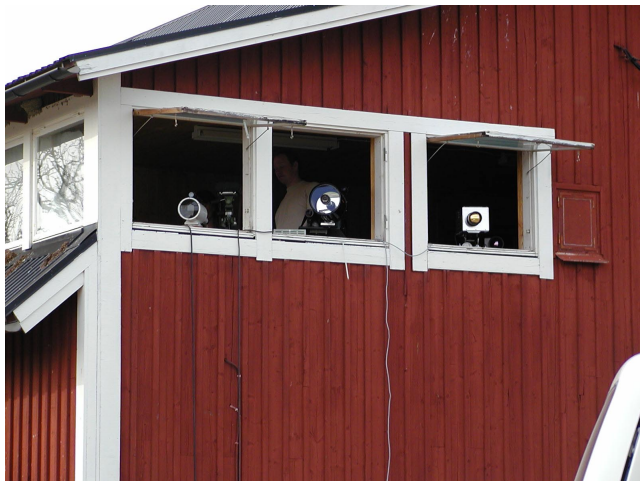
Figur 2.3. (från Figur 2.2) Sensorernas placering inomhus. Vänstra fönstret: scintillometerns mottagarenhet; mittfönstret: GV-enheten; högra fönstret : MULTIMIR och (knappt synlig) QWIP-kamera.
