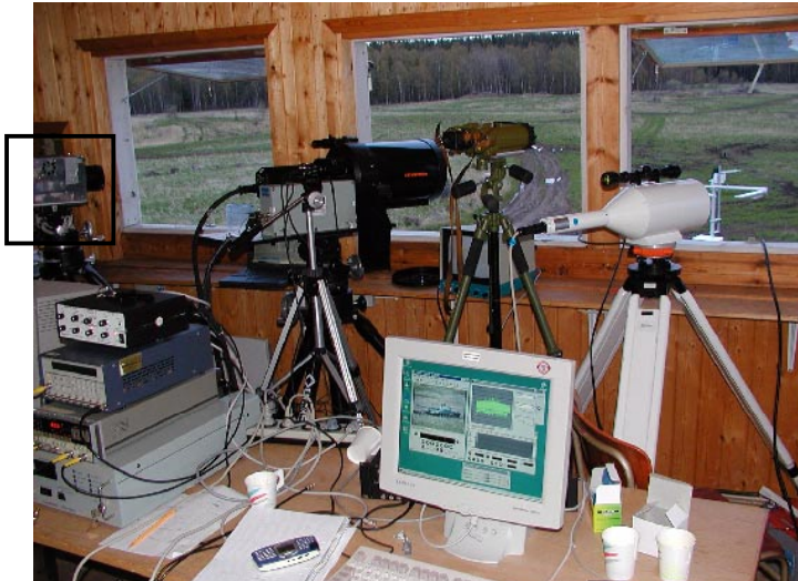
Figur 2.4. Den gemensamma uppställningsplatsen inomhus. Inramad längst till vänster syns MULTIMIR. Längst till höger syns scintillometerns optiska mottagare. De två instrumenten placerade framför mittfönstret är GV-enhet (vänster) och avståndsmätare (höger)
