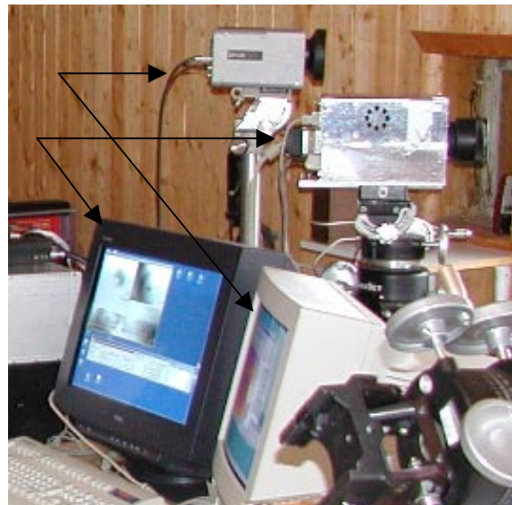
Figur 2.5. Den gemensamma uppställningsplatsen inomhus. Bilden visar MULTIMIR och QWIP-kameran med tillhörande svart respektive vit skärm.
