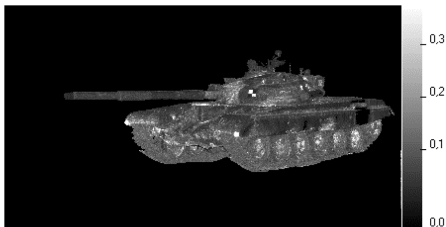
Figur 4.29. Intensitetsbild av T72 Kvarn. Skalan är angiven som ekvivalent reflektionskoefficient.
