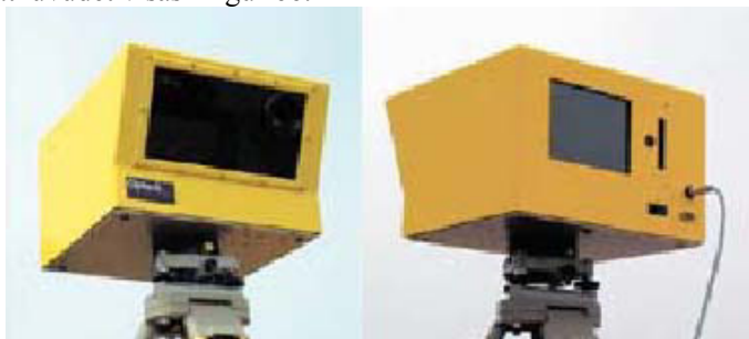
Figur 66. Mät huvudet till ILRIS-3D. På framsidan (bilden till vänster) syns fönstret bakom vilken sändare och mottagare samt digitalkamera finns. På baksidans display (bilden till höger) visas bilden från digitalkameran.
