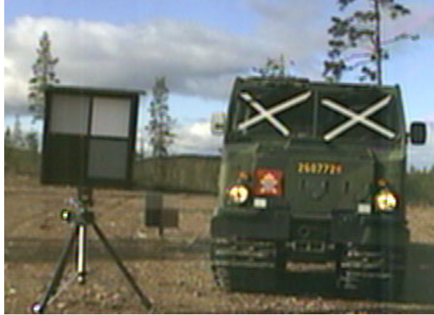
Figur 17. Kalibreringstavla med fyra kända reflektanser samt bandvagn som objekt (från Ålvdalen oktober 2002).
