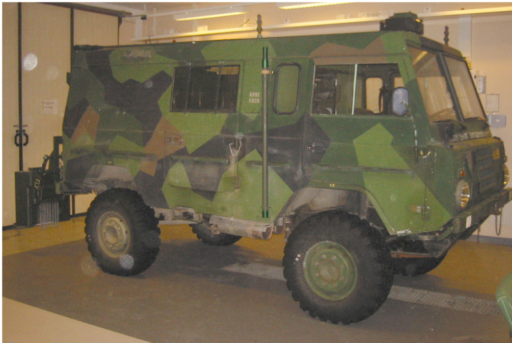
Figur 5. Terrängbil med indikeringsutrustning. I lådan längst bak finns markindikeringsutrustningen GARDS som är uppbyggd kring AP2C. På taket fram sitter en låda som bland annat innehåller ett RAID instrument.
