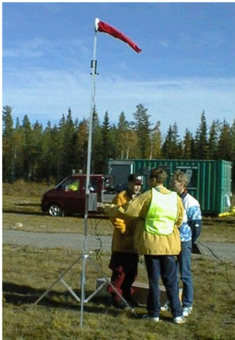
Figur 12. En mobil väderstation kan grupperas på kort tid och därefter kontinuerligt leverera lokal väderinformation. (Fotograf: Johan Jenvald).
