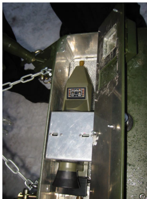
Figur 6. AP2C-instrument som en komponent i markindikeringsutrustningen GARDS. GARDS är monterat bak på en terrängbil (vänster). Markmaterial som lossnar från däckan på terrängbilen fångas upp och upphettas. Ångorna passerar AP2C-instrumentet som indikerar förekomsten av C-stridsmedel (höger). En detaljerad beskrivning finns i rapporten Indikeringsystem för C i mark och N/C i luft: prototyp integrerad för PATRIA XA203S (Berglund et al. , 2002).
