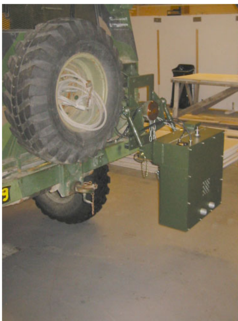
Figur 6. AP2C-instrument som en komponent i markindikeringsutrustningen GARDS. GARDS är monterat bak på en terrängbil (vänster). Markmaterial som lossnar från däckan på terrängbilen fångas upp och upphettas. Ångorna passerar AP2C-instrumentet som indikerar förekomsten av C-stridsmedel (höger). En detaljerad beskrivning finns i rapporten Indikeringsystem för C i mark och N/C i luft: prototyp integrerad för PATRIA XA203S (Berglund et al. , 2002).
