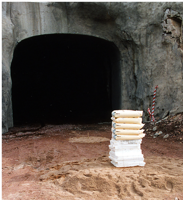
Bild 3. 125 kg Prillit 5m utanför tunnelmynningen, försök 809.
