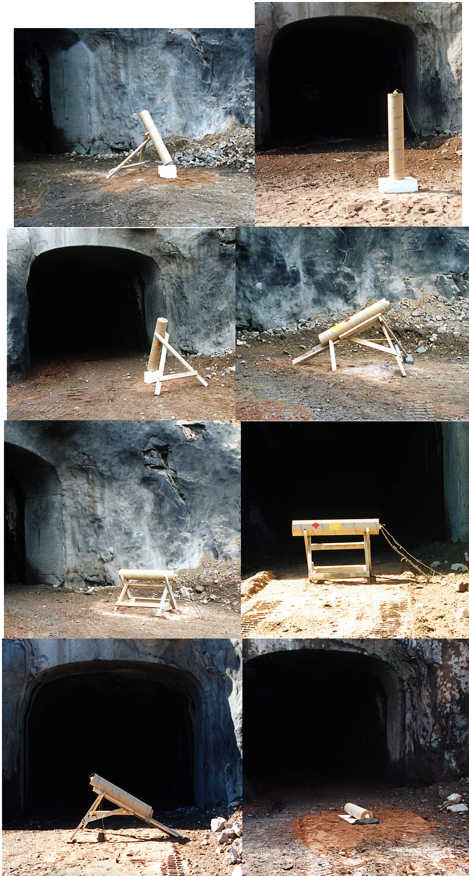
Bild 4. Olika placeringar av cylinderladdningarna. Alla på 5 meters avstånd.
