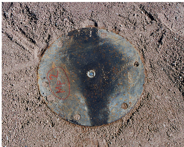
Bild 1. Mät punkt 2. Side-On givare på platta.
