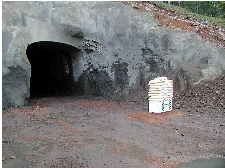
Bild 5. En 625 kg laddning på 10 meters avstånd från tunnelmycket.
