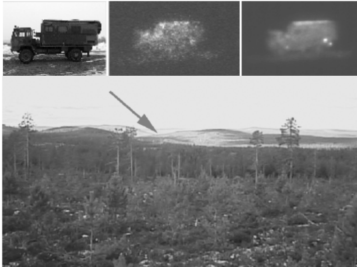
Figur 9.4 Exempel på grindad avbildning för måligenkänning på långa avstånd (14 km) från FOI-prov i Älvdalen. Överst t.v. terrängbil på nära håll, i mitten bild från en laserpuls och t.h. 8 pulser. Laservåglängd 0,532 \mu\text{m} .
