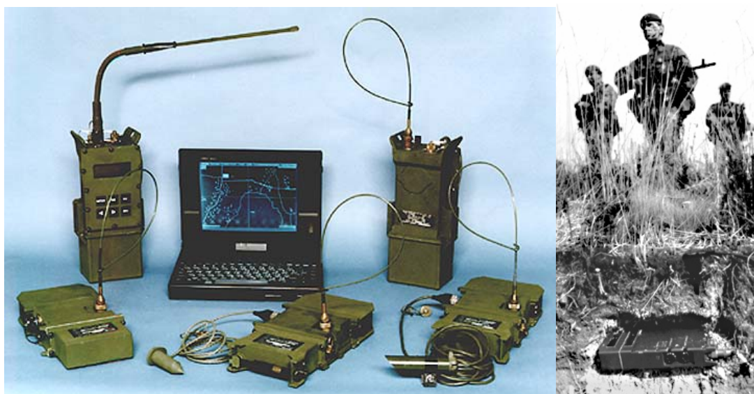
Multispektral sensor IREMBASS med IR, akustisk, seismisk, magnetisk sensor[22]
