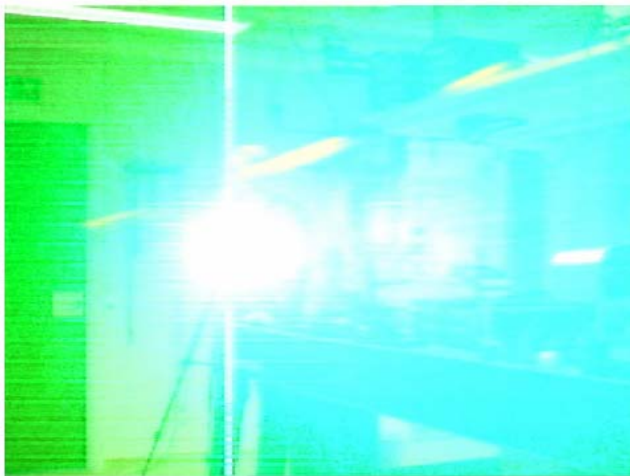
Figur 9.9 Resultatet av bländning av videokamera (VIS) med 1 mW dubblad Nd:YAG-laser [27].
