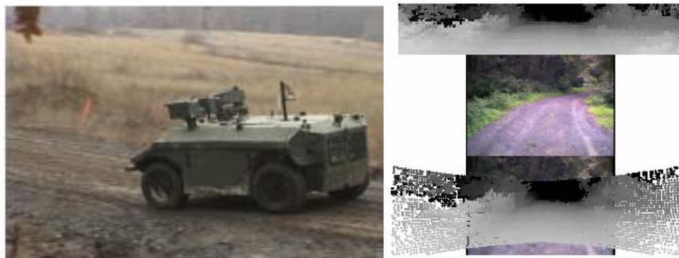
XUV. T.v. ett provfordon för autonom navigation. T.h. fusionerad laseravstånd och färd TV bild . Från Rasmussen [24].
