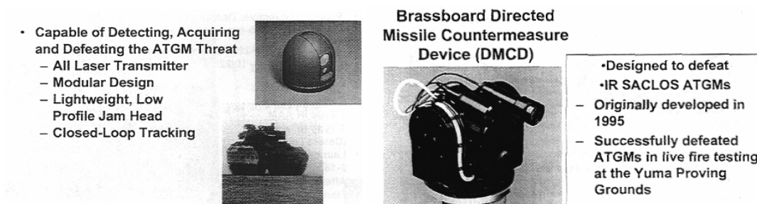
Figur 9.13 Exempel på utveckling av fordonsbaserat motmedelssystem som använder laser för att vilseleda ATGM="anti tank guided missile"s. Bild Northrop Grumman.
