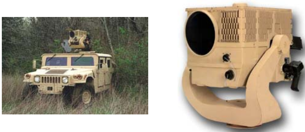
Figur 9.8 Multispektral sensor LRAS3 med IR/VIS [21].
