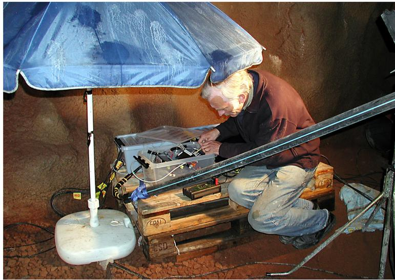
Figur 6. Anslutning av givarna till förstärkarna.
