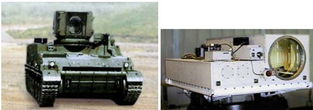
Figur 31. Exempel på "first-generation optical countermeasures laser system" utvecklat av Granat Design Bureau, Ryssland. http://www.milparade.com/2001/48/03_05.shtml . Enligt uppgift kan utrustningen avge pulser med 2000 J pulsenergi-en puls som om den kan sändas med 10 Hz eller med närmar sig den allmändetråkuktiva laservapennivån.
