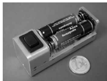
Figur 82. Demonstration av en enkel kavitet för att faskoppla olika delar (stripes) från en diodlaser med stor tvärsnittsyta. Principen (t.v.) bygger på att lasern får operera i en viss vinkel relativt den optiska axeln i en stabil resonans. Bilden t.h. visar en diodlaser som ger 0.4 W driven av två AA uppladdningsbara batterier. Våglängd 940 nm. Från Raab 29 et.al.
