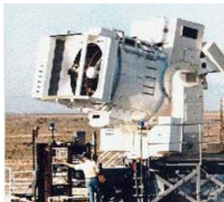
Figur 17. Laser (överst) Sea-Lite Beam Director nu ingående i HELSTF , High Energy Laser Systems Test Facility, i White Sands USA. Sårbarhetstest vid laserverkan mot en trycksatt ICBM efterliknande yttre påverkan som uppstår vid uppskjutningsfas(nedre figurer). Ref. se Internet och HELSTF.
