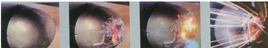
Figur 73. 10 kW laser vid 1.06 \mu\text{m} som bestrålar av TOW 2A robotdom i realistiskt luftflöde. 6 pulser a 500 J (totalt 3 kJ) räcker för att kortsluta anslagszonröret så att roboten skulle ha detonerat i förtid. Från Jane's Int. Def. Rev 56 .
