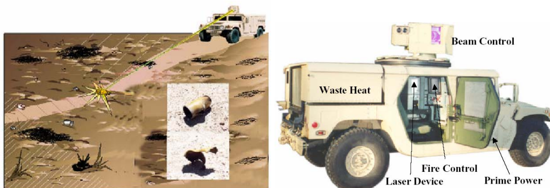
Figur 13. ZEUS™ utnyttjas en synlig laser och en kamera för att hitta minor och stridsdelar och en 500 W-1 kW för att förstöra dessa på upp till 300 m avstånd.
