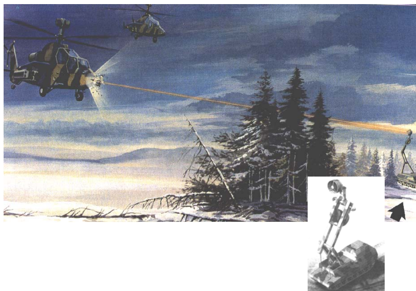
Figur 19. Det tyska projektet HELEX som avsåg demonstrera ett laservapen med en gasdynamisk CO 2 -laser monterat på ett stridsvagnschassi. Uteffekt i området 0,3-3 MW beroende på användning, motsvarande spegeldiameter 0,7-1,5 meter.
