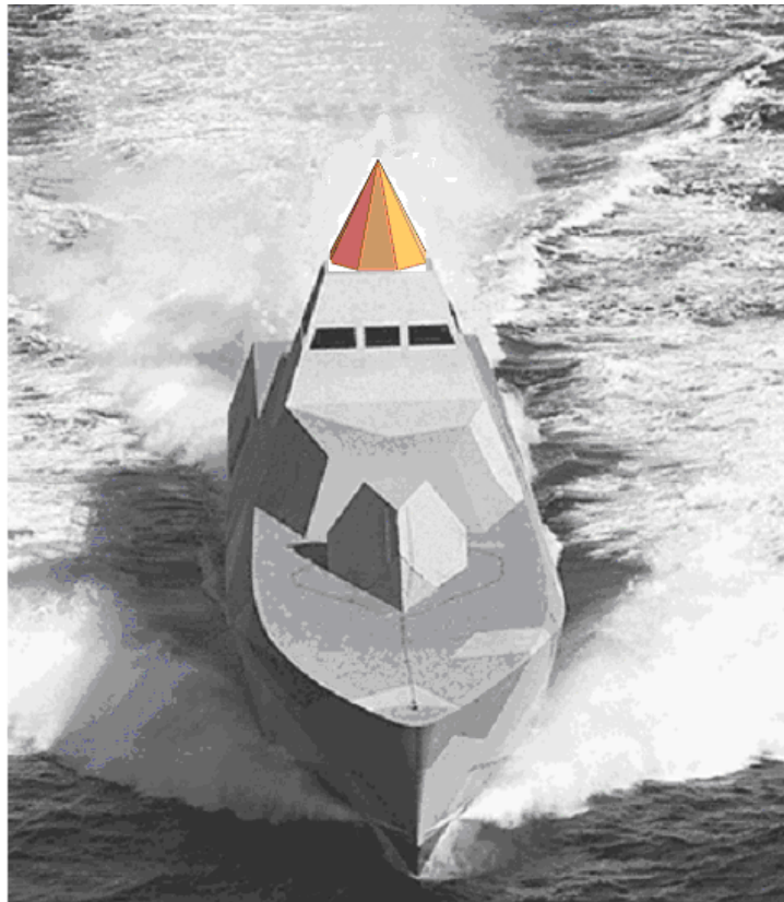
Figur 6.1: Exempel på antennplacering av pyramidantenn på smygfartyg. Ursprungsbild: Copyright © Kockums AB.
