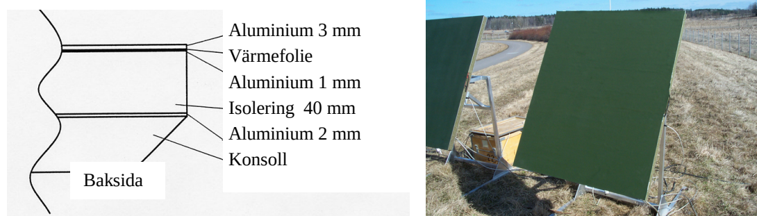
Figur 10 Paneler sedda från sidan (vänster) och foto av paneler uppställda på mätplatsen (höger). I fotot är den målade panelen till vänster.
