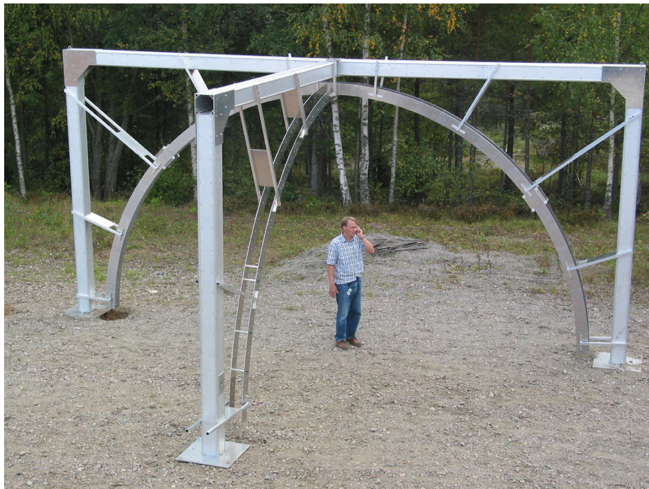
Figur 2. FOIs mätbåge. Bågradien är 3,5 meter. Stativet kan justeras i höjd m.h.a. domkrafter vid stativbenen för att få bågcentrum på samma nivå som markplanet och justera in vinkelskalans nollpunkt.
