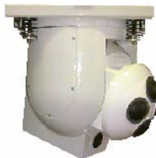
Figur 10. SMU:ns mät huvud. SMU:n har 4 spiralantennor för mätning. Nederst syns den videokamera som används för följning.
