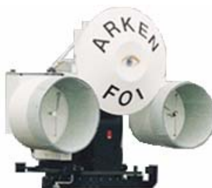
Figur 6. Närbild av Arkens antennenkonfiguration. Vänster antenn är sändande, höger är mottagande och antennen i mitten är en följeantenn av monopulstyp.
