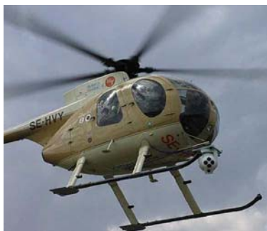
Figur 9. Signalmätutrustning SMU monterad på helikopter. Under cockpit syns SMU:ns mät huvud. Övrig utrustning är monterad i helikoptern.
