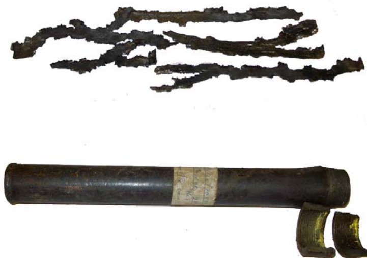
Figur 7 Resultat av detonerbarhetsprov med 25 mm rör. NaCl (överst), Hexotol (mitten) och FOF-2 (nederst).
