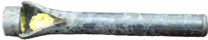
Figur 9 Resultat från detonerbarhetsprov på FOF-4 med 25 mm rör.
