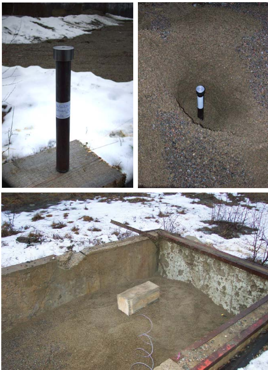
Figur 14 Försöksuppställning detonerbarhetsprov (diameter = 25 mm).
