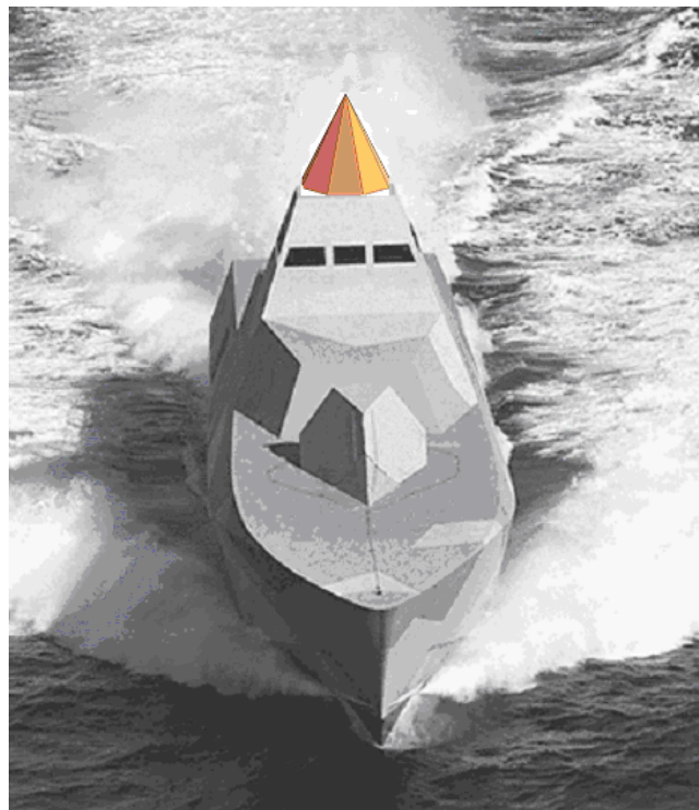
Figur 29. Exempel på antennplacering av pyramidantenn på smygfartyg. Ursprungsbild Copyright © Kockums AB.
