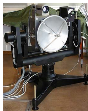
Figur 16. Vridbordet med den gamla radarutrustningen monterad. Kontrollerdatorn syns ej på bilden.
