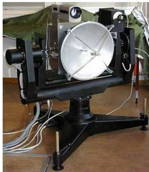
Figur 1. Mätsystem med styrbar plattform, skannande mm-vågsradar, IR-kamera och videokamera.
